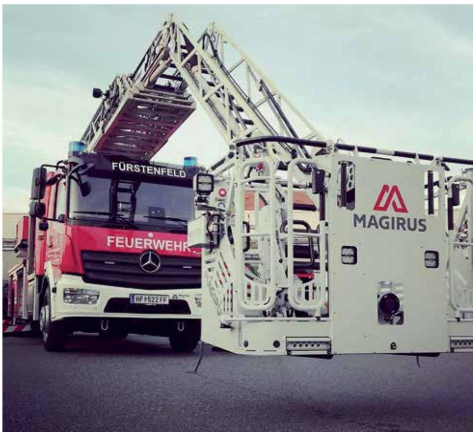
ten Kreuzes montiert werden. Somit ist es möglich, Personen aus Häusern mit verwinkelten Stiegenhäusern über das Fenster zu retten. Außerdem ist es möglich, Kameraden vom Korb aus seiltechnisch zu sichern. Dies ist zum Beispiel beim Schneeabschaufeln von Dächern erforderlich. Des Weiteren können am Korb ein Wasserwerfer oder ein Druckbelüfter montiert werden. Eine Sprühanlage im Korbboden ist zum Selbstschutz beim Brandeinsatz ebenfalls eingebaut.
